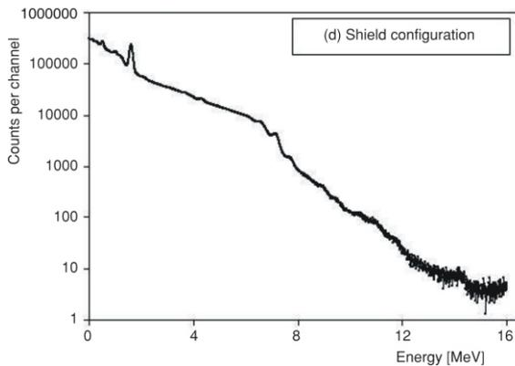
**Figure 7.** Prompt gamma ray spectrum of urea with (d) structure
