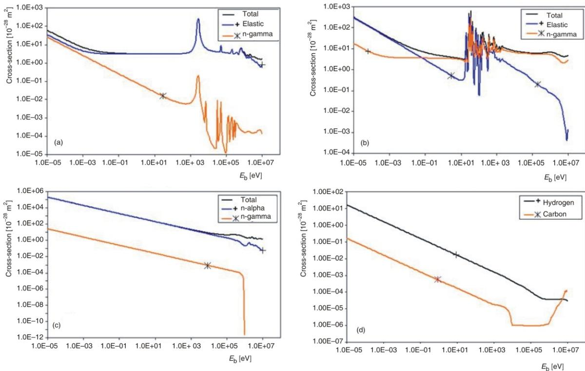
**Figure 2. Neutron cross-section: (a)  $^{23}\text{Na}$ , (b)  $^{127}\text{I}$ , (c)  $^{10}\text{B}$ , and (d)  $^1\text{H}$  and  $^{12}\text{C}$**
